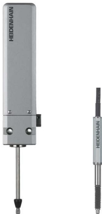
В случае **инкрементальных линейных датчиков** текущая координата отсчитывается от нулевой точки путем подсчета импульсов. Для воспроизведения нулевой точки инкрементальные датчики фирмы HEIDENHAIN имеют референтные метки, которые необходимо проехать после включения оборудования. Особенно просто и быстро это происходит в датчиках с кодированными референтными метками.
