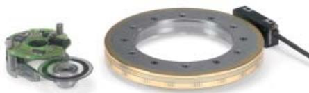
В случае **инкрементальных датчиков угла и датчиков вращения** текущая координата вала определяется исходя из нулевой точки, путем считывания шагов измерения или деления и считывания импульсов сигнала. Для воспроизведения нулевой точки инкрементальные датчики фирмы HEIDENHAIN имеют референтные метки, которые необходимо проехать после включения оборудования.
