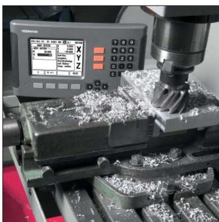
УЦИ на фрезеровочном станке
