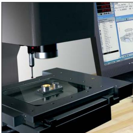
Решение для измерительной машины на основе ПК
