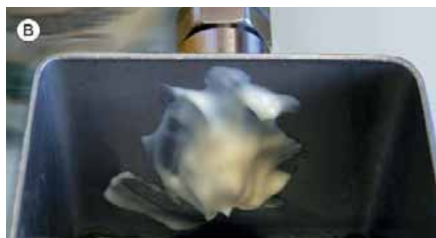
(A) Датчик LMT контролирует уровень майонеза с помощью технологии профиля спектра емкости на высокой частоте. (B) Датчик надежно обнаруживает опустошение резервуара и нечувствителен к осадку жидкостей и другим отложениям.
