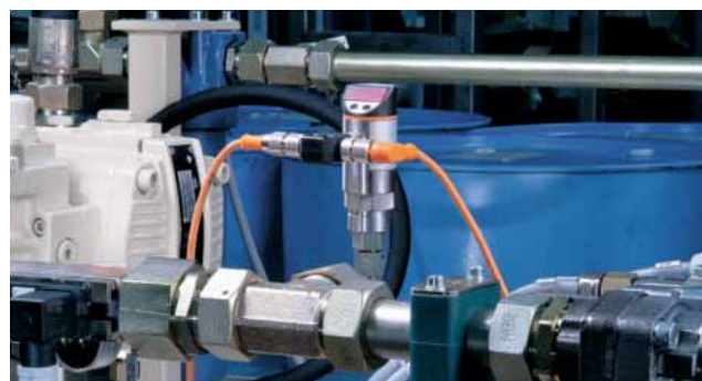
Измерение дифференциального давления при контроле фильтра.
