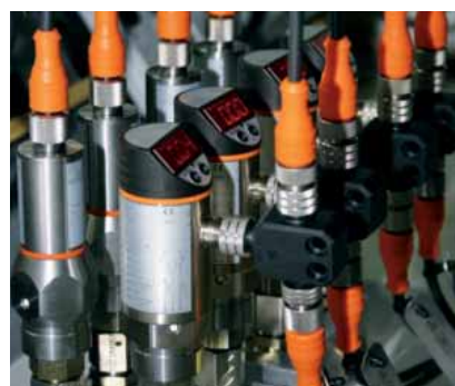
Измерение дифференциального давления при контроле фильтра.
