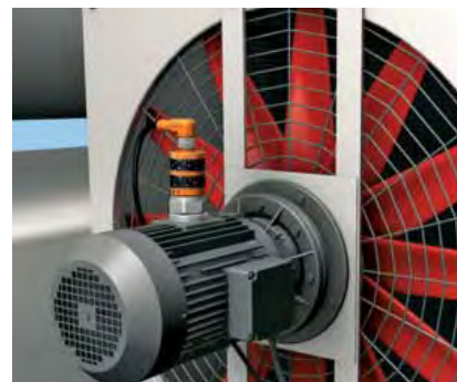
Контроль суммарной вибрации вращающихся частей (вентиляторы, центрифуги, и т. д.).
