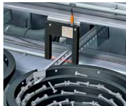
Точное обнаружение винтов в подающих механизмах и системах.
