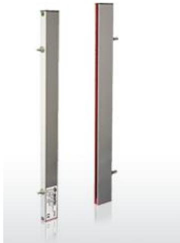
Они работают по принципу нескольких сквозных световых барьеров со связанными выходными сигналами. Если случайный световой луч между передатчиком и приемником прерывается, то активируется выход оценки электроники. В зависимости от типа света завесы, оценка электроники либо интегрирована в полосы световых завесов, либо действует в качестве внешнего усилителя в отдельном корпусе.
