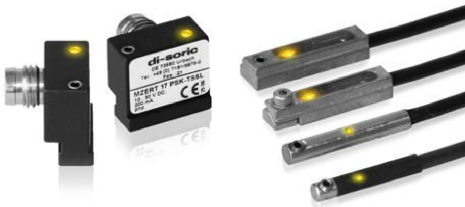
Датчики цилиндров di-soric предназначены для пневматических цилиндров со встроенными магнитами. Положение поршня сканируется индуктивно через стенку цилиндра. Эти датчики предлагают высокую степень безопасности и надежности.
